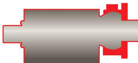
Abhängig von den Gegebenheiten vor Ort kann der EMO III-Oszillator mit einer separaten Halteplatte oder mit einem Flansch, als integrierter Bestandteil des Doppelrohrspritzrohres, angebracht werden. Die „In-Line“-Flanschmontage ist hier die bevorzugte und einfachere Art der Installation, da keine zusätzliche Konsole benötigt wird.
